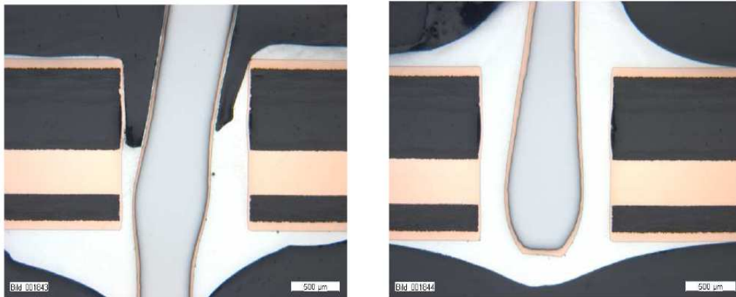
Abb. 4.3.30: Schliffbilder Elko - Pin 1 (links) und Pin 2 (rechts) - Variante 3, 285 °C, 2 Sekunden
